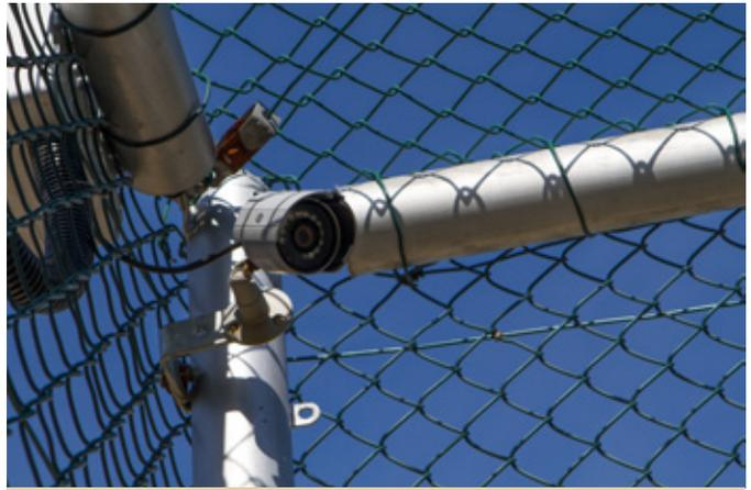
Cámara fija con leds infrarrojos.
