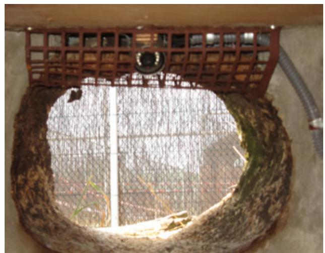
Cámara fija con leds infrarrojos y protección anti-mordeduras instalada en el interior de una paridera.
