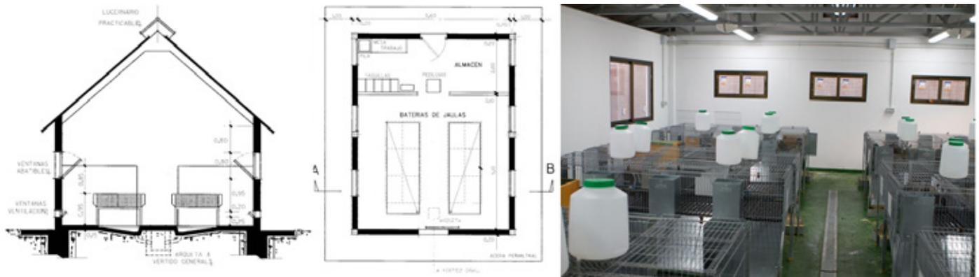
Figura 4.4. Alzado, planta y fotografía del almacén de presas vivas de un centro de cría
