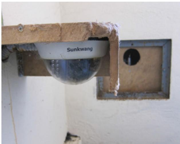
Cámara fija con leds infrarrojos utilizada para vigilar el interior de un cajón paridera.
